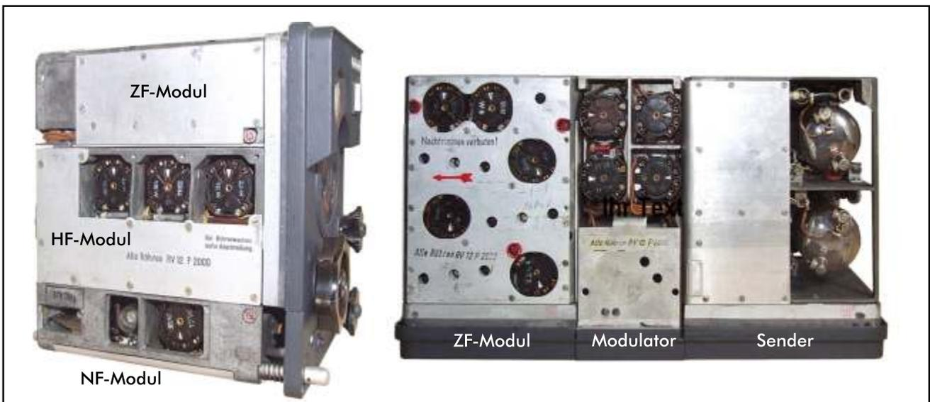
das sei vor der Behandlung der Schaltungstechnik des FuG 16 angemerkt – wären frequenzstabile freilaufende Oszillatoren, wie sie bei den Geräten der Wehrmacht ganz überwiegend verwendet wurden, nicht realisierbar gewesen, schon gar nicht bei den in Flugzeugen herrschenden Vibrations- und Beschleunigungsbedingungen.
