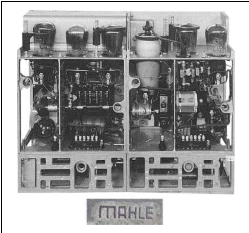
Links, Bild 5: Lorenz Funksprechgerät O (1931) Modularer Chassisaufbau aus Gußteilen der Firma MAHLE (Firmenlogo) (aus Trenkle, verändert)
